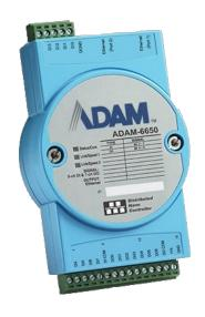
ドライ・ウェットコンタクト対応 、 I/Oタイプ:12ch DI&6ch DO マルチプロトコル対応: Modbus/TCP, TCP/IP, UDP, HTTP, DHCP, SNMP, MQTT
