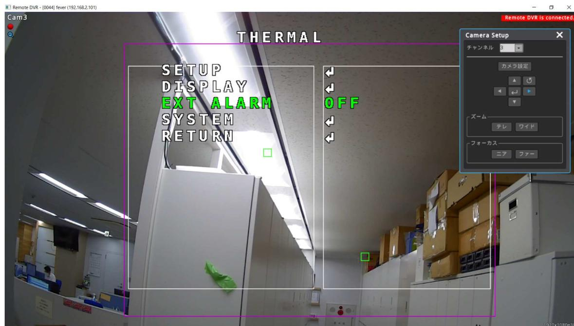
【EXT ALARM】を選択して、左右ボタンで「OFF」「OUTPUT」を選択します。「OUTPUT」を選択するとカメラ本体から出ているケーブルの2芯線よりアラーム検知した際に出力されます。
